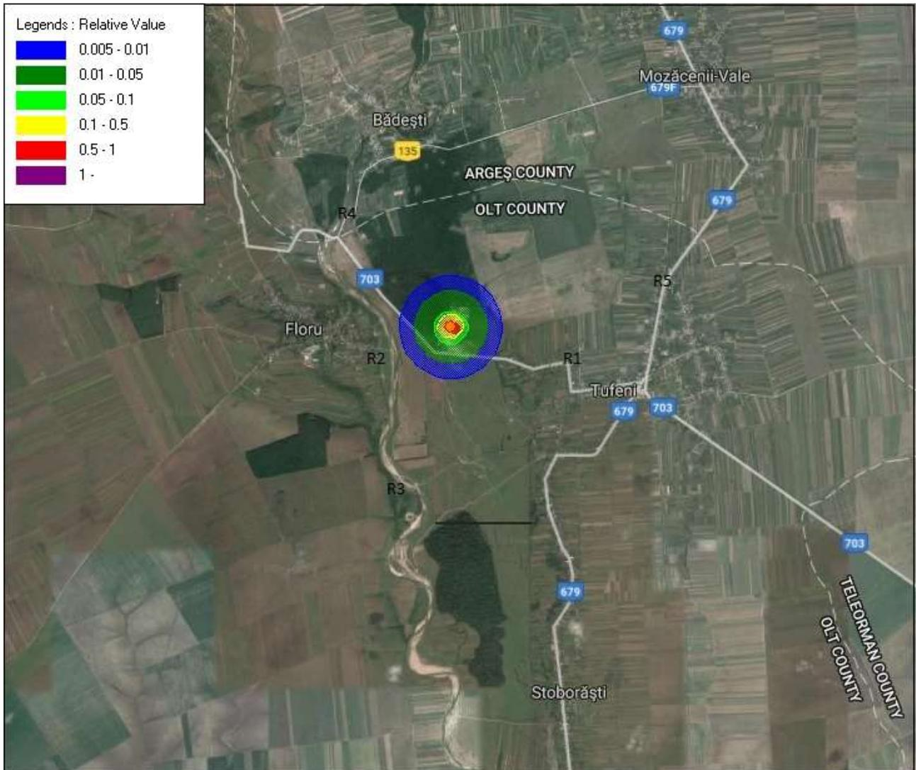
**Modelare 1.** Emisia de amoniac; direcția vântului – NE; viteza vântului = 0 m/s; clasa de stabilitate atmosferică – A, temperatura = -10°C; timp de funcționare = 1 an, 24 h/zi. . R1,R2, R3, R4, R5, =0 mg/mc; Limita impusă de STAS 12574/1987 este de 0,1mg/mc. Concentrația maximă înregistrată la receptori este sub valoarea limită.
