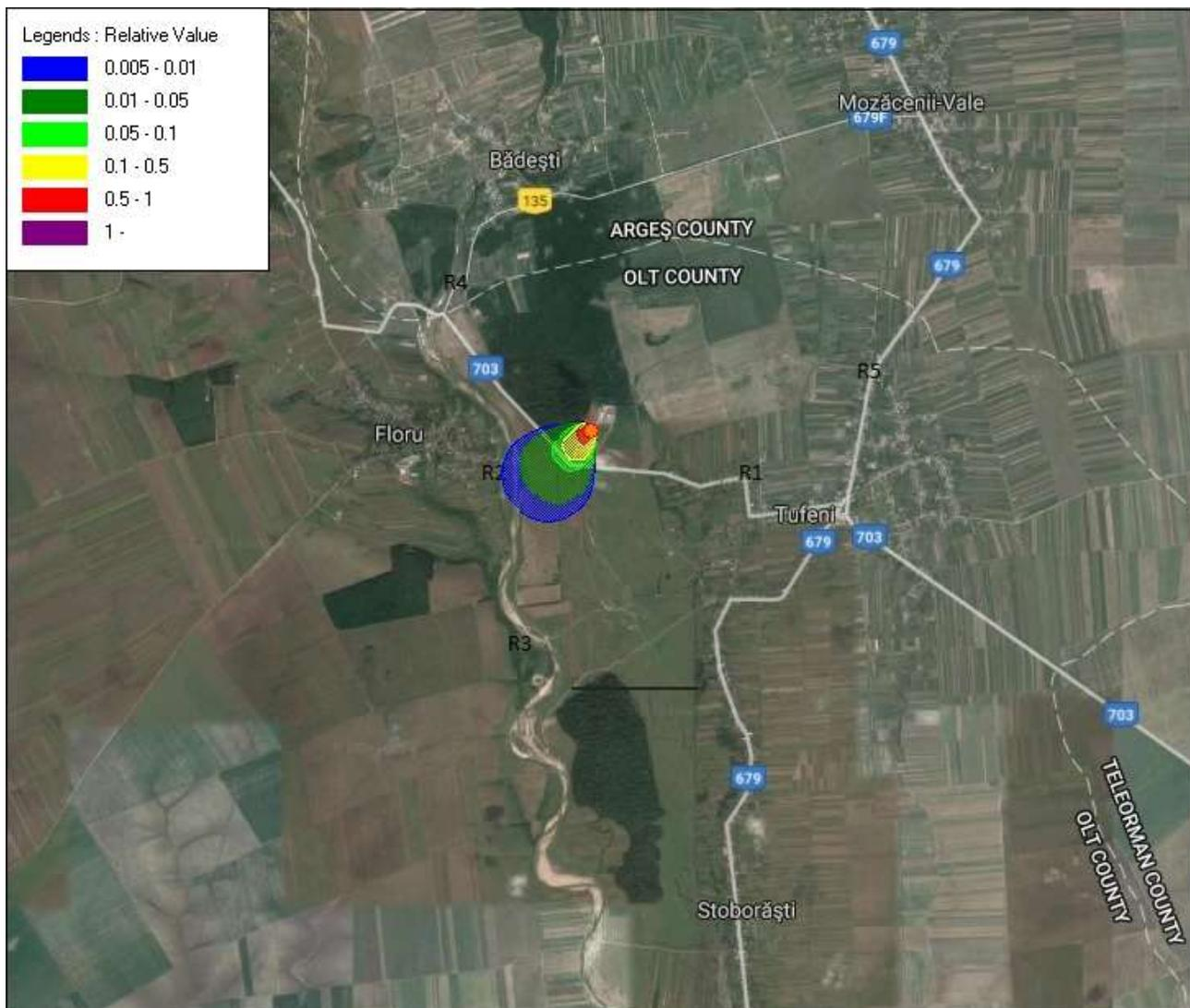
**Modelare 2.** Emisia de amoniac; direcția vântului – NE; viteza vântului = 5 m/s; clasa de stabilitate atmosferică – A, temperatura =  $-10^{\circ}\text{C}$ ; timp de funcționare = 1 an, 24 h/zi. . R1, R3, R4, R5, = 0 mg/mc; R2 = 0,001 mg/mc; Limita impusă de STAS 12574/1987 este de 0,1mg/mc. Concentrația maximă înregistrată la receptori este sub valoarea limită.
