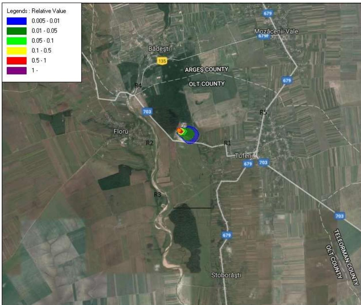
**Modelare 4.** Emisia de amoniac; direcția vântului – VNV; viteza vântului = 3m/s; clasa de stabilitate atmosferică – A, temperatura =  $-15^{\circ}\text{C}$ ; timp de funcționare = 1 an, 24 h/zi. R2, R3, R4, R5, =0 mg/mc; R1 = 0,002 mg/mc; Limita impusă de STAS 12574/1987 este de 0,1mg/mc. Concentrația maximă înregistrată la receptori este sub valoarea limită.
