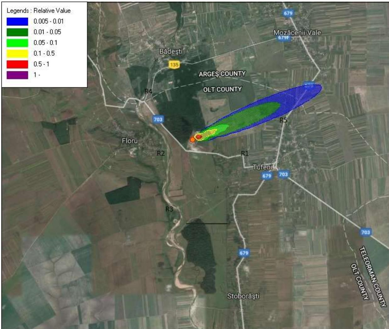
**Modelare 5.** Emisia de amoniac; direcția vântului – VSV; viteza vântului = 2 m/s; clasa de stabilitate atmosferică – C, temperatura = 30°C; timp de funcționare = 1 an, 24 h/zi. . R1, R2, R3, R4, = 0 mg/mc; R5 = 0,002 mg/mc; Limita impusă de STAS 12574/1987 este de 0,1mg/mc. Concentrația maximă înregistrată la receptori este sub valoarea limită.
