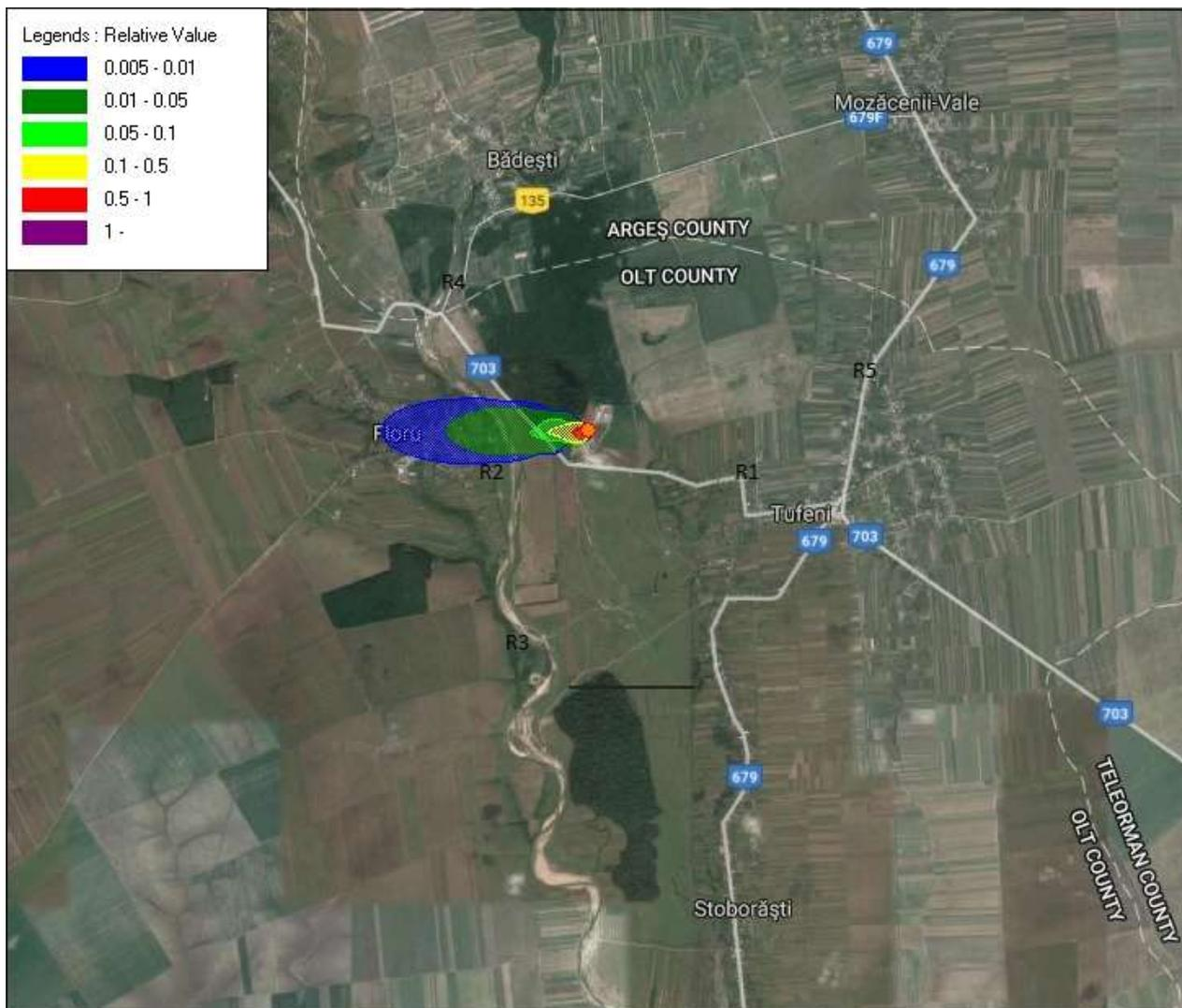
**Modelare 3.** Emisia de amoniac; direcția vântului – E; viteza vântului = 2 m/s; clasa de stabilitate atmosferică – C, temperatura = -5°C; timp de funcționare = 1 an, 24 h/zi. . R1, R3, R4, R5, = 0 mg/mc; R2 = 0,03 mg/mc; Concentrație max. râu Vede = 0,1062 mg/mc; Limita impusă de STAS 12574/1987 este de 0,1mg/mc. Concentrația maximă înregistrată la receptori este sub valoarea limită.
