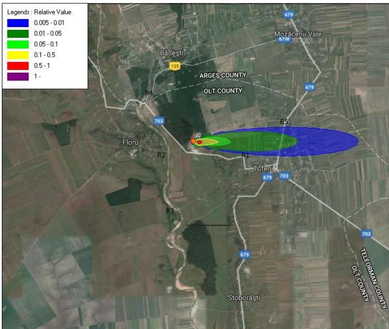
**Modelare 6.** Emisia de amoniac; direcția vântului – E; viteza vântului = 2 m/s; clasa de stabilitate atmosferică – DD, temperatura = 25°C; timp de funcționare = 1 an, 24 h/zi. . R2, R3, R4, = 0 mg/mc; R1 = 0,004 mg/mc; R5 = 0,013 mg/mc; Limita impusă de STAS 12574/1987 este de 0,1mg/mc. Concentrația maximă înregistrată la receptori este sub valoarea limită.
