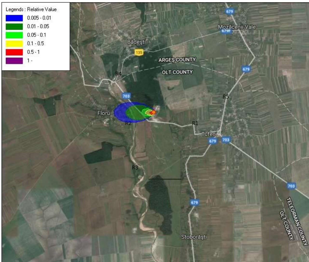
**Modelare 7.** Emisia de amoniac; direcția vântului – E; viteza vântului = 2 m/s; clasa de stabilitate atmosferică – B, temperatura = 15<sup>0</sup>C; timp de funcționare = 1 an, 24 h/zi. . R1, R3, R4, R5 = 0 mg/mc; R2 = 0,002 mg/mc; Concentrația max. Râu Vedea = 0,042 mg/mc; Limita impusă de STAS 12574/1987 este de 0,1mg/mc. Concentrația maximă înregistrată la receptori este sub valoarea limită.
