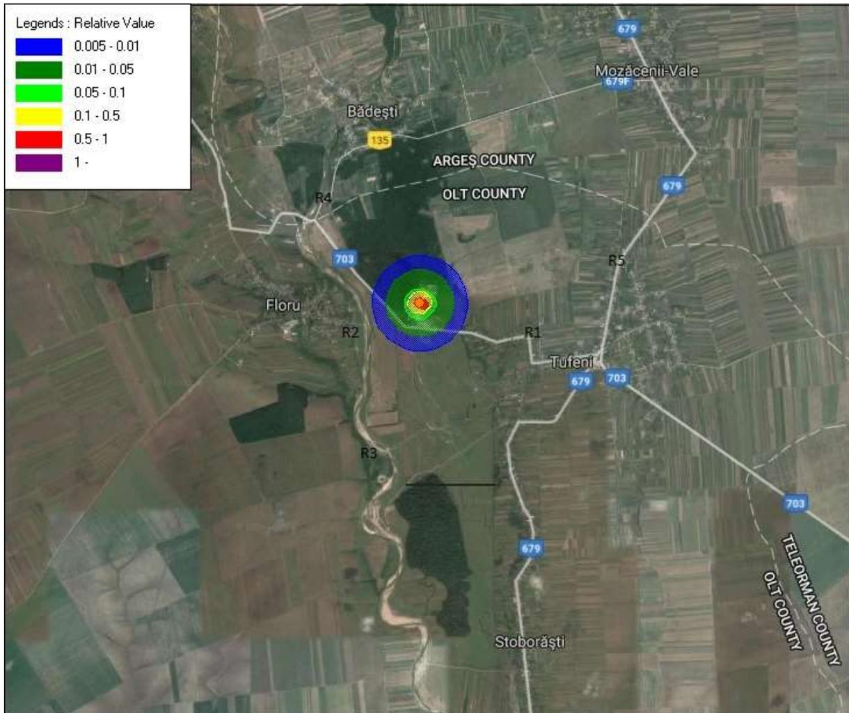
**Modelare 8.** Emisia de amoniac; direcția vântului – N; viteza vântului = 0 m/s; clasa de stabilitate atmosferică – A, temperatura = 30°C; timp de funcționare = 1 an, 24 h/zi. . R1, R2, R3, R4, R5 = 0 mg/mc; Limita impusă de STAS 12574/1987 este de 0,1mg/mc. Concentrația maximă înregistrată la receptorii este sub valoarea limită.
